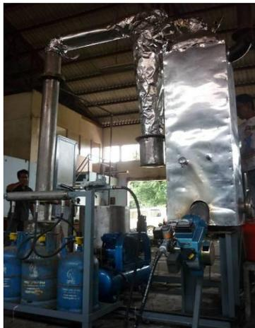
Gambar 13. Instalasi tabung gas LPG menuju ke burner
