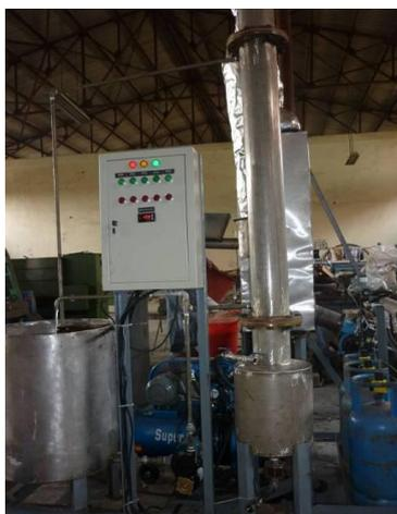
Gambar 14. Rangkaian panel box control ke setiap peralatan dan komponen lainnya
