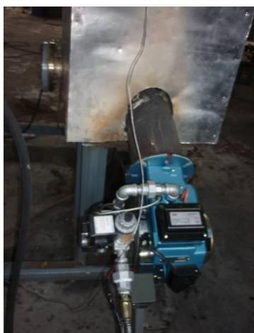
Gambar 11. Instalasi *burner LPG* dan sistem termostat pada pipa lorong api
